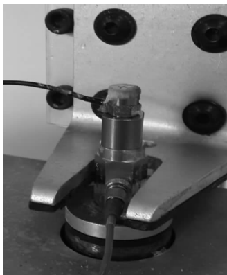
图 8 1175#传感器金属块转接安装方式
