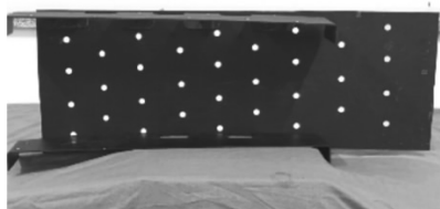
(a) 零件表面的动态编码点
