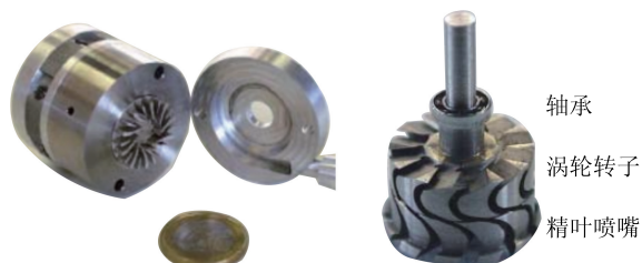
图 2 压气机样机及轴承转子部件
