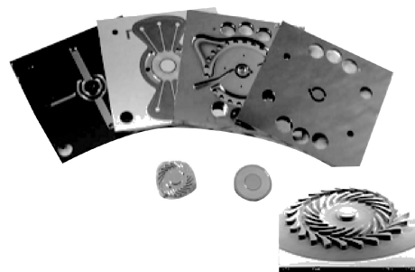
图8 组成发动机的硅片及叶片部分放大图 [40]
