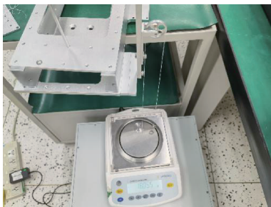
图10 弱阻尼滑轮摩擦力测试实物图
